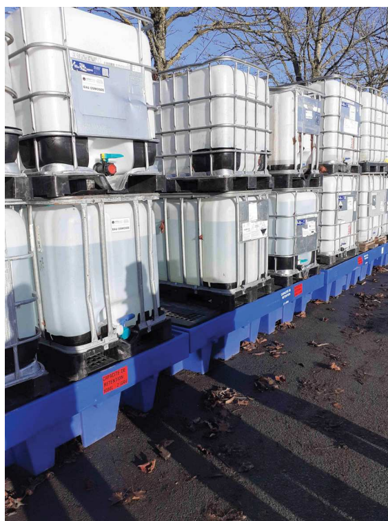
stockage d'eau osmosée sur rétention
